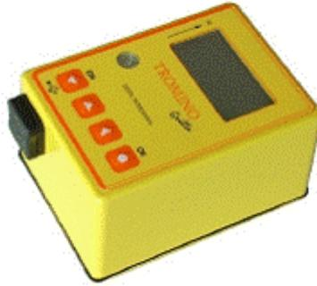
**INDAGINE SISMICA mediante la tecnica del rapporto spettrale H/V a stazione singola eseguita con tromografo digitale TROMINO-Micromed ed elaborazione dei dati mediante software GRILLA-Micromed**
